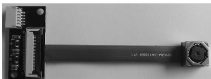
Fig. 5. Micro camera “OV5640 USB camera module”. (例 : <https://www.amazon.co.jp/USB%E3%82%AB%E3%83%A1%E3%83%A9%E3%83%A2%E3%82%B8%E3%83%A5%E3%83%BC%E3%83%AB%E3%80%81OV5640-1944P%E3%82%AA%E3%83%BC%E3%83%88%E3%83%95%E3%82%A9%E3%83%BC%E3%82%AB%E3%82%B9OTG-USB%E3%82%AB%E3%83%A1%E3%83%A9%E3%83%A2%E3%82%B8%E3%83%A5%E3%83%BC%E3%83%ABfor-Android-Windows/dp/B081JQHLWN>)
